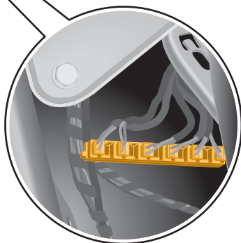
разделитель проводов 1 систем шин, под приборной панелью спереди слева
